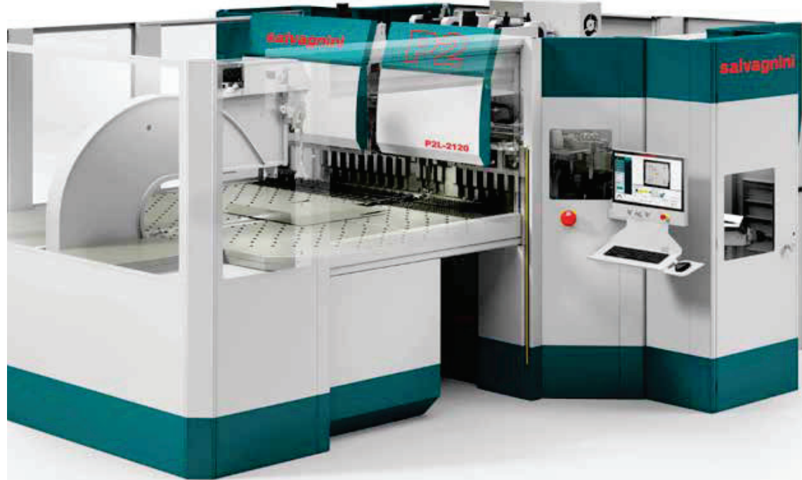
Die P2 ist ein kompaktes Biegezentrum, das Umrüstvorgänge beim Produktionswechsel reduziert und Ausschuss minimiert, ja sogar eliminiert.
